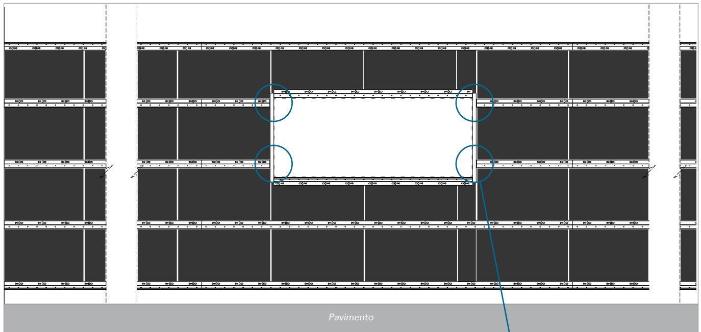
Posizionare le prime clip di fissaggio più vicine ai profili terminali. Utilizzare il righello di guida in base alla scelta della lamella.
