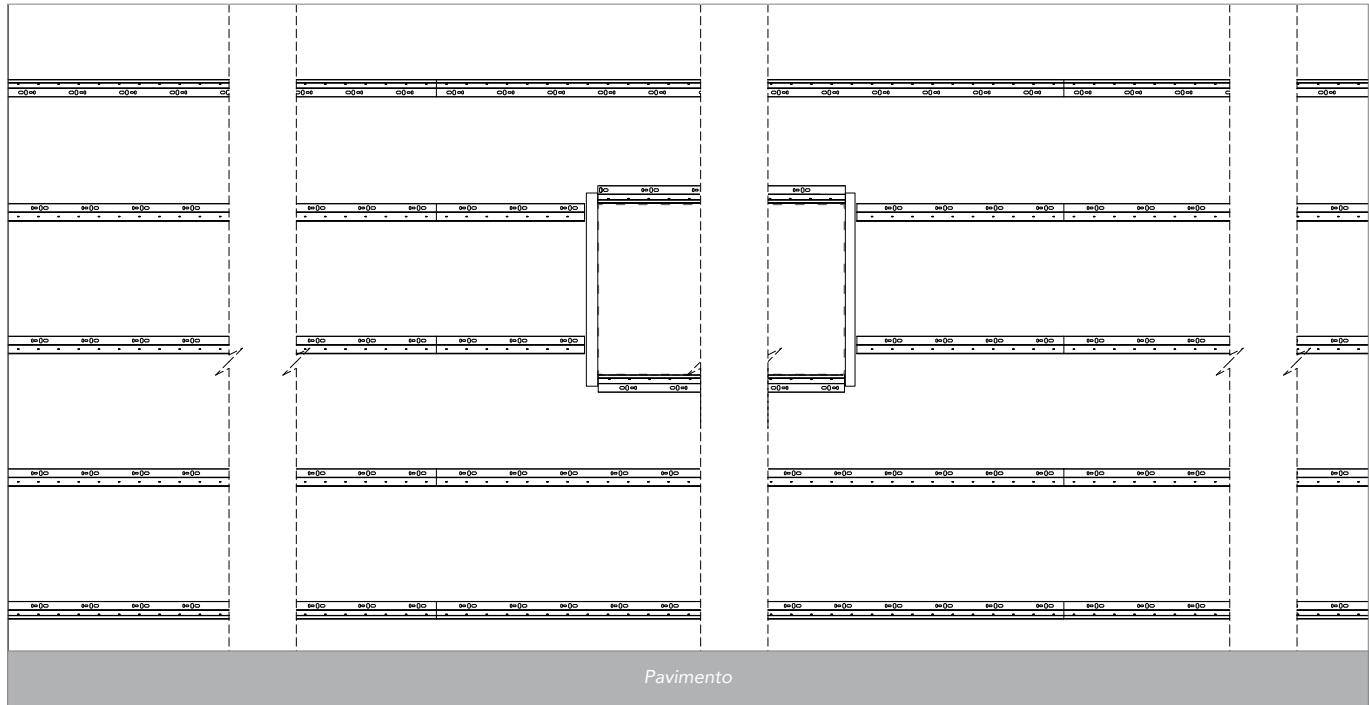
Montare i profili (superiore e inferiore) con le teste delle viti orientate verso l'esterno rispetto all'intelaiatura.
