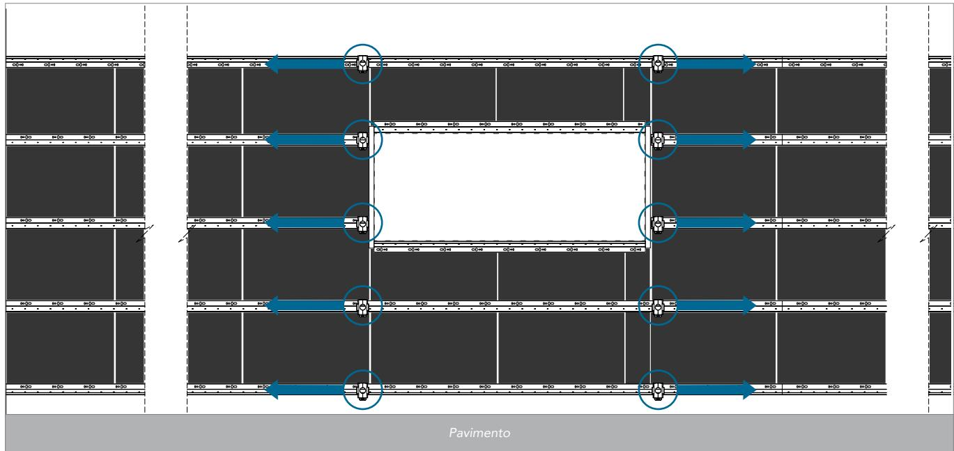
Montare tutte le clip utilizzando il righello di guida, ad eccezione delle clip sui profili orizzontali sopra e sotto l'intelaiatura.
