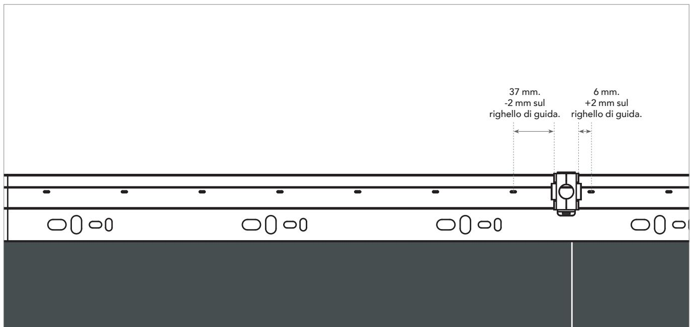
Misurare la distanza dal lato della clip di fissaggio al centro del foro di allineamento più vicino nel profilo. La distanza determina quale spaziatura utilizzare sul righello di guida quando si posizionano le clip di fissaggio successive:
