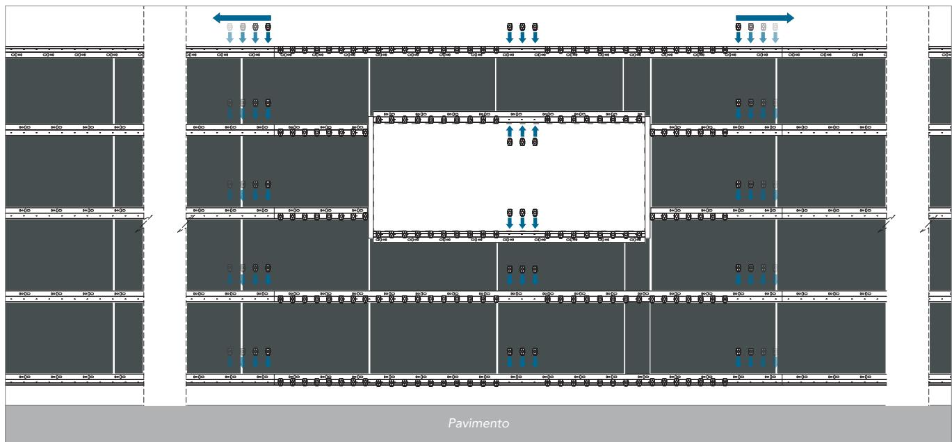
Posizionare le clip di fissaggio rimanenti utilizzando i fori di allineamento dei profili orizzontali dell'intelaiatura.
