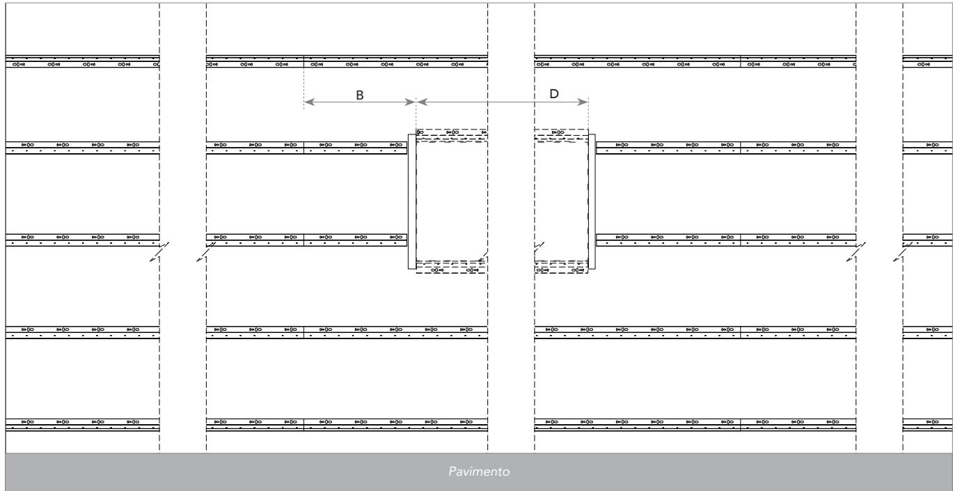
Misurare la distanza dell'intelaiatura verticale alla giunzione/estremità del profilo più vicina (B). Prendere due profili superiore/inferiore (!) e capovolgerne uno (a) prima di effettuare il segno per il taglio. Tagliare i due profili superiore/inferiore a ciascuna estremità, in corrispondenza della misura B.
