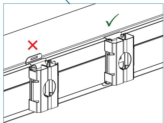
**21** Fissare le clip di fissaggio rimanenti sui profili orizzontali dell'intelaiatura.
