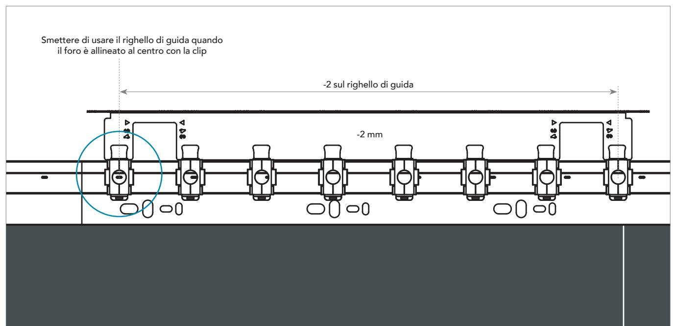
Esempio: 15 mm non sono compresi tra 21,1 mm e 51,5 mm = utilizzare il lato +2 mm del righello di guida.
