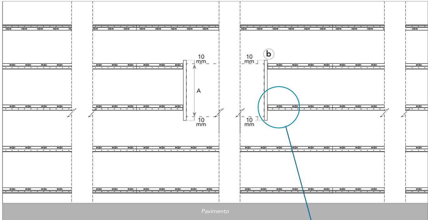
Montare i due profili di estremità utilizzando la staffa di connessione terminale.
