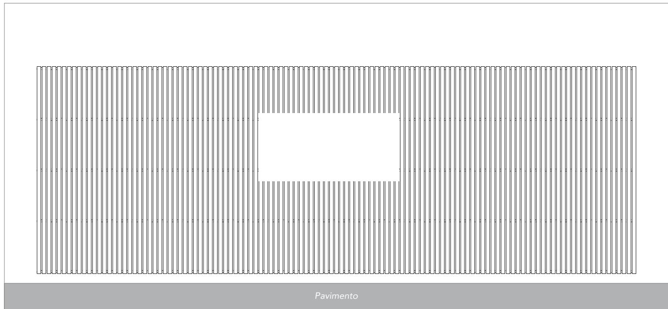
*Tagliare e montare le lamelle facendo pressione sulle clip di montaggio.*
