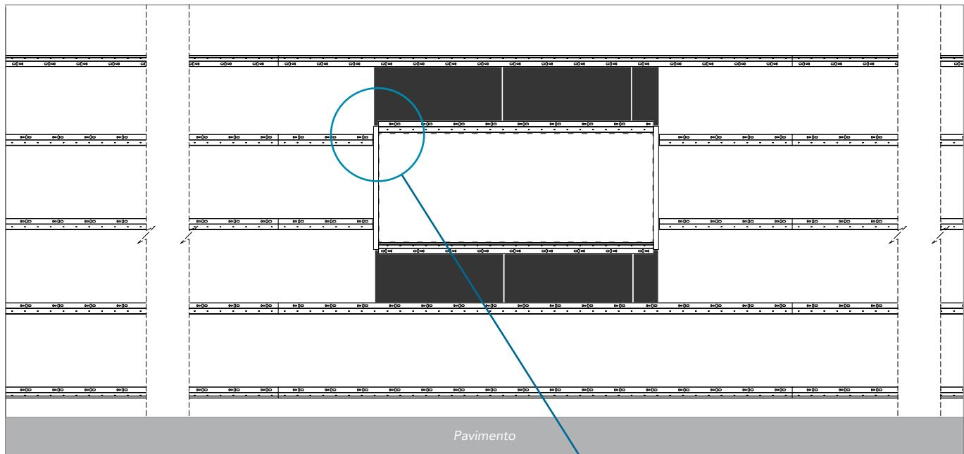
Tagliare e montare i pannelli sopra e sotto l'intelaiatura. Le estremità dei pannelli devono terminare a circa 15 mm dall'esterno dell'intelaiatura.
