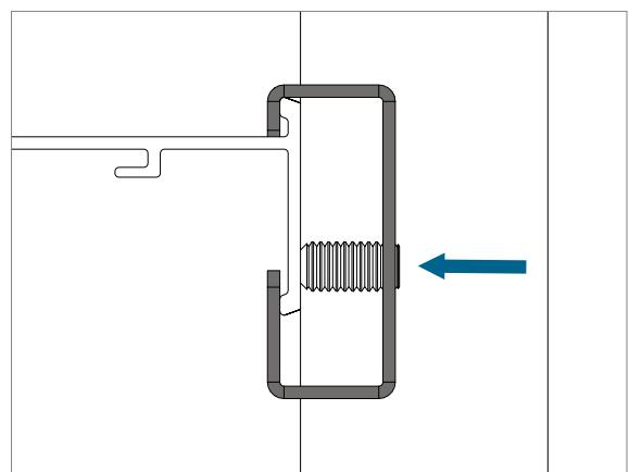
Stringere la vite di fissaggio per bloccare la staffa universale al profilo intermedio.
