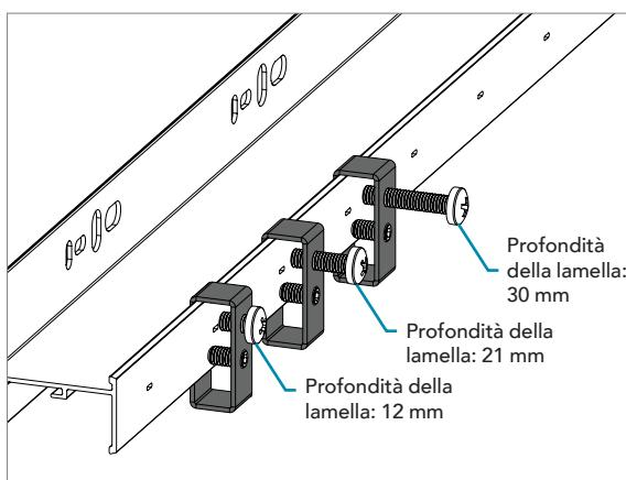
Assicurarsi di selezionare la vite che corrisponde alla variante di profondità delle lamelle più alta applicata nel progetto.
